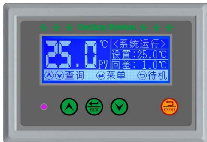
名称：冷水机/冷油机温控器
