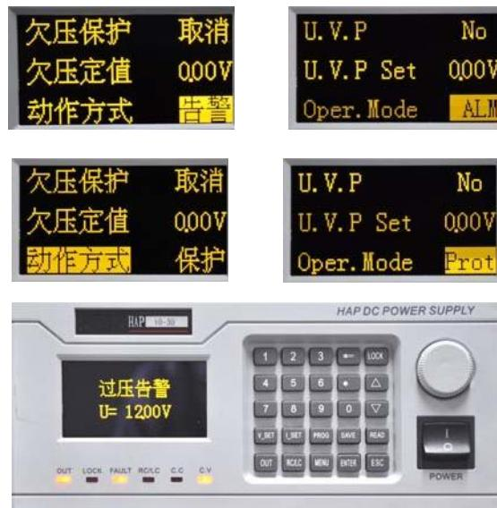
选择“电流保护”菜单项，按 **ENTER** 确认键进入电压保护设置界面。
