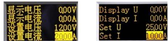
7.4.6、输出电压和输出电流设置完成后，按 **OUT** 键，“OUT”指示灯亮，电源有输出。在电源输出状态按 **OUT** 键，电源输出将被关闭，“OUT”指示灯熄灭。
