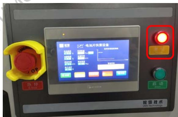
**灯塔：**红灯闪烁表示有报警，需及时处理，黄灯表示暂停/待机/停机、绿灯表示设备正常运行状态
