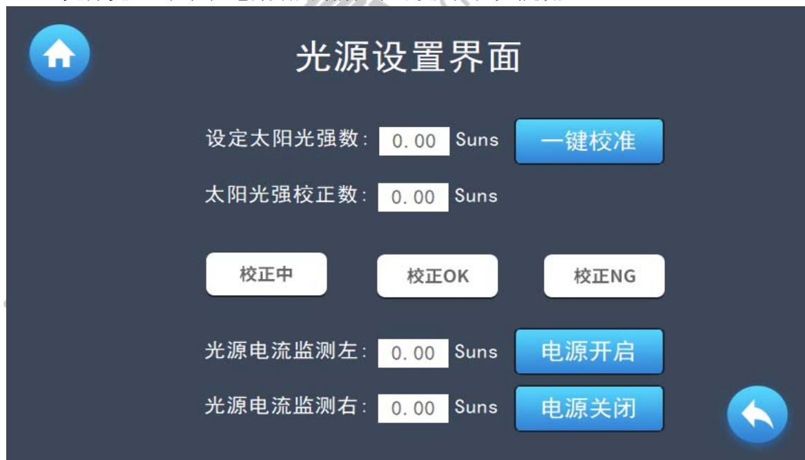
1. 在设定太阳光强处可设置所需太阳光强 (0–20Suns), 并保证程控电源处于开机状态, 然后点击一键校准, 设备会依据所需光强, 与程控电源通讯, 设置相应的电压及电流; 同时光强探头会伸出检测光源光强, 检测数据显示于校准数一栏, 校正 OK 亮起光源则正常运行;
