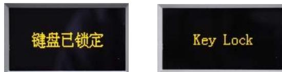
再次按 **LOCK** 键后，键盘锁定被解除，“LOCK”指示灯熄灭，所有键盘的功能都被恢复。
