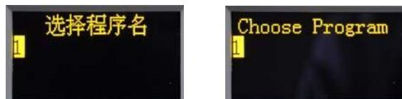
如需要进行已经选择的程序输出，在待机状态界面按  $\text{PROG}$  键，电源开始按选择的程序输出，再次按  $\text{PROG}$  键，可以停止输出。
