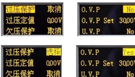
选择“过压定值”菜单项，按  $\text{ENTER}$  确认键进行过电压保护值设置，键入保护电压值后按  $\text{ENTER}$  确认键退出。
