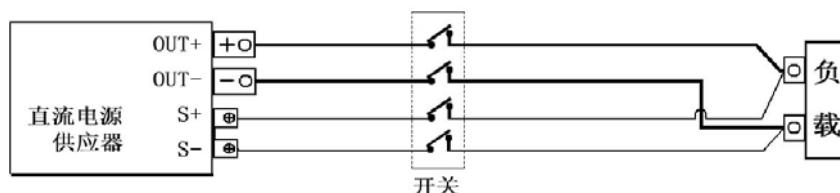
5.10、负载的电阻值改变会使实际输出电流超出设定电流值，输出电压将会降低，此时，电源供应器的工作模式将由定电压模式转为定电流模式。因此，在设定电流值时应考虑适当的富裕量，以避免电源供应器工作于频繁的模式转换状态。
