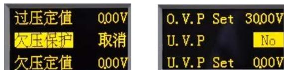
选择“欠压定值”菜单项，按 **ENTER** 确认键进行欠电压保护值设置，键入保护电压值后按 **ENTER** 确认键退出。
