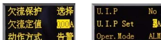
选择“动作方式”菜单项，按 **ENTER** 确认键进行电流保护模式设置，选择“告警”模式，在电源出现电流保护时，会显示告警提示，不会停止电源输出。选择“保护”模式，在电源出现电流保护时，会显示告警提示，故障指示灯“FAULT”点亮，同时停止电源输出。
