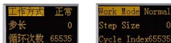
选择“工作方式”菜单，按  $\text{ENTER}$  确认键进入工作方式设置，按  $\Delta$  键或  $\nabla$  键可分别选“正常”、“恒压 (C.V)”、“恒流 (C.C)”工作模式。选择后按  $\text{ENTER}$  确认键退出。
