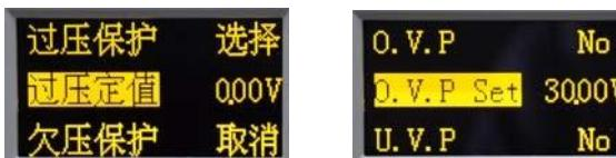
选择“欠压保护”菜单项，按  $\text{ENTER}$  确认键进行欠电压保护功能设置，按  $\Delta$  键 或  $\nabla$  键进行功能选择，选择“选择”表示保护功能有效，选择“取消”则保护功能无效。
