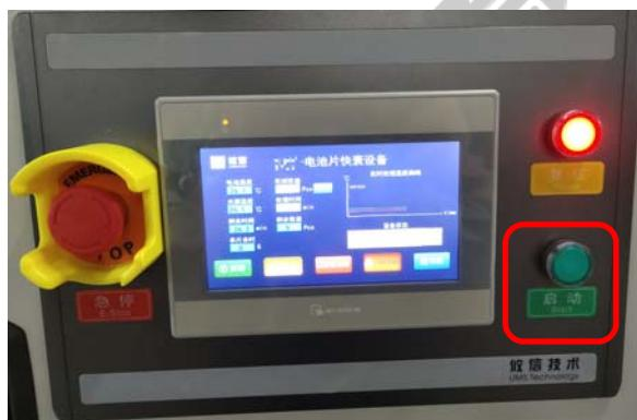
**复位按钮灯：**当设备某工位有强制动作时或自动运行中途停止时亮起，除了自动运行过程中的停止行为，其他情况下在自动运行前需要按复位键进行工序复位。
