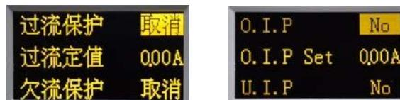
选择“过流定值”菜单项，按 **ENTER** 确认键进行过电流保护值设置，键入保护电流值后按 **ENTER** 确认键退出。
