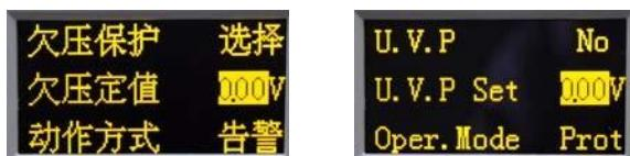
选择“动作方式”菜单项，按 **ENTER** 确认键进行电压保护模式设置，选择“告警”模式，在电源出现电压保护时，会显示告警提示，不会停止电源输出。选择“保护”模式，在电源出现电压保护时，会显示告警提示，故障指示灯“FAULT”点亮，同时停止电源输出。
