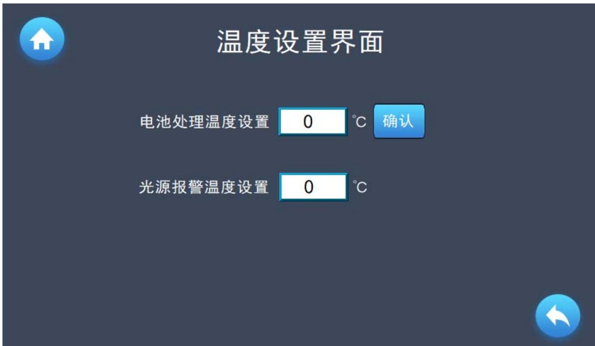
1. **电池处理温度设置:** 开机后可设置电池片所需处理温度, 范围为 50–150°C;
