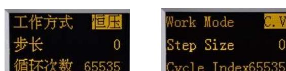
选择“步长”菜单，按  $\text{ENTER}$  确认键进入步长设置，根据需要设定程序的步长，本产品步长支持多达1-99步。设置完成后按  $\text{ENTER}$  确认键退出。
