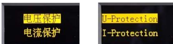
选择“电压保护”菜单项，按  $\text{ENTER}$  确认键进入电压保护设置界面。
