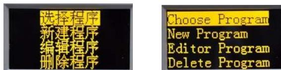
按  $\Delta$  键或  $\nabla$  键选择“选择程序”菜单项，按  $\text{ENTER}$  确认键进入选择程序操作界面。选已经被保存的程序，按  $\text{ENTER}$  确认键，然后按  $\text{ESC}$  退出键返回待机界面。
