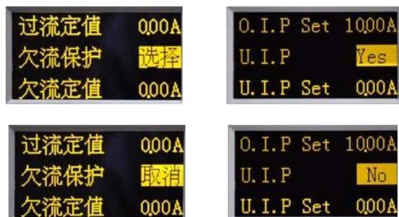
选择“欠流定值”菜单项，按 **ENTER** 确认键进行欠电流保护值设置，键入保护电流值后按 **ENTER** 确认键退出。
