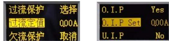
选择“欠流保护”菜单项，按 **ENTER** 确认键进行欠电流保护功能设置，按 **△** 键或 **▽** 键进行功能选择，选择“选择”表示保护功能有效，选择“取消”则保护功能无效。
